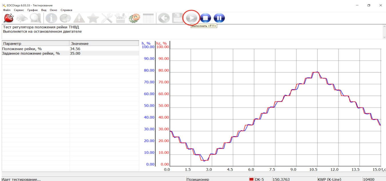
Рисунок 14. Тест подвижности рейки
